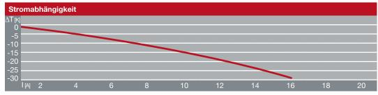
Abhängig von thermischer Ankopplung, Leitungsdimensionierung, äußeren Einflüssen.
